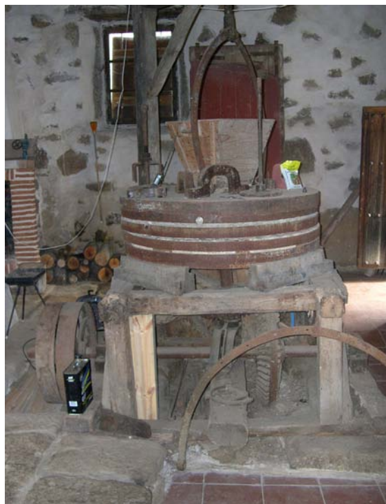
Maquinaria de molienda del molino de Villar de la Corneja, conservada en perfecto estado, son visibles las dos muelas y los ejes de transmisión
