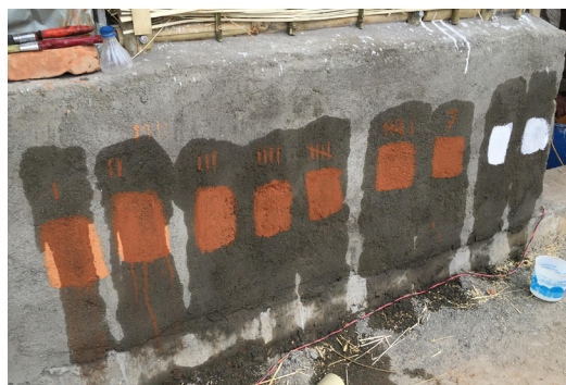
Figura 8. Ensayo realizado en obra para estudiar el comportamiento frente al agua de las pinturas de arcilla estabilizada con estabilizante químico (caseína y cola blanca).
