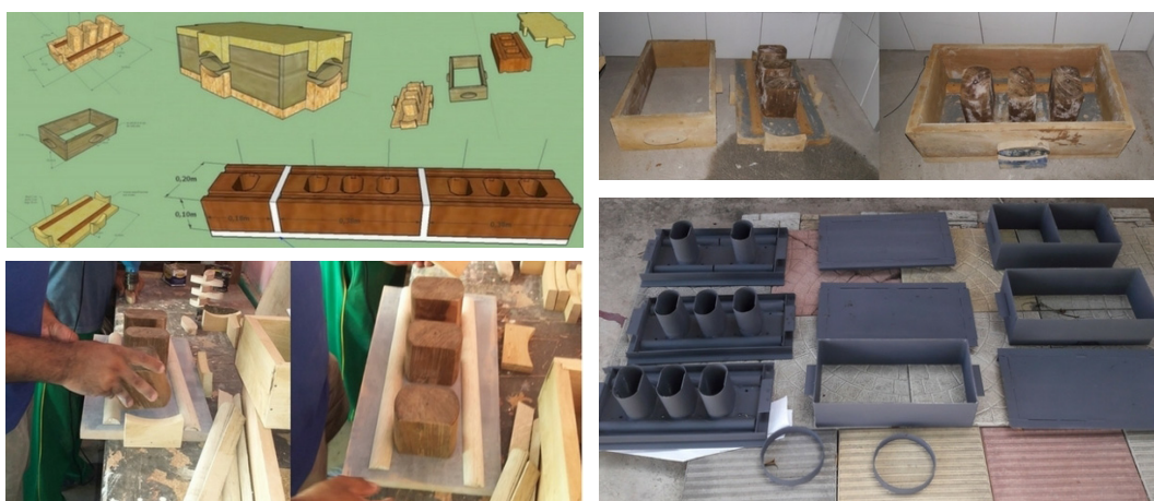
Figura 5. Diseño, elaboración de molde en madera y metálico para adobes, vereda J10 del municipio de Tibu, región del Catatumbo, Norte de Santander, Colombia. Fuente: Oswaldo Hurtado Figueroa, Instructor SENA, Regional Norte de Santander, Centro C.I.E.S.
