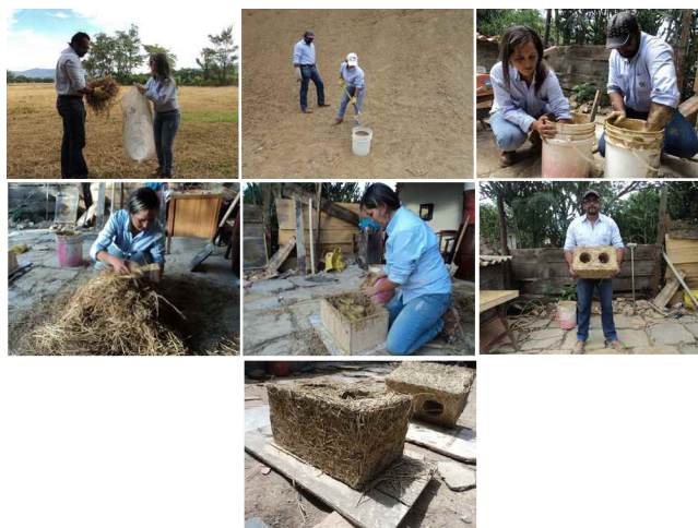
Figura 6. Vista elaboración de bloque térmico de arcilla y paja en el municipio del Tarra, región del Catatumbo, Norte de Santander, Colombia. Fuente: Oswaldo Hurtado Figueroa, Instructor SENA, Centro CIES.
