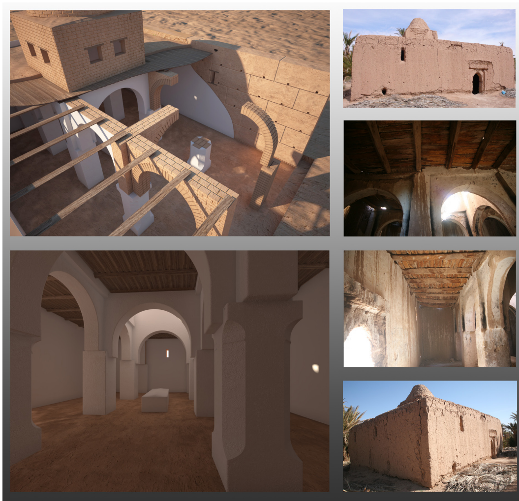
Figura 5. Infografías 3D: hipótesis constructiva en 3D del morabito de Sidi Bou Guertif y vista interior 3D del estado original del morabito. Fuente: S. Lillo. Fotografías derecha: estado actual del morabito Fuente: Rodríguez&Gil, abril 2014.
