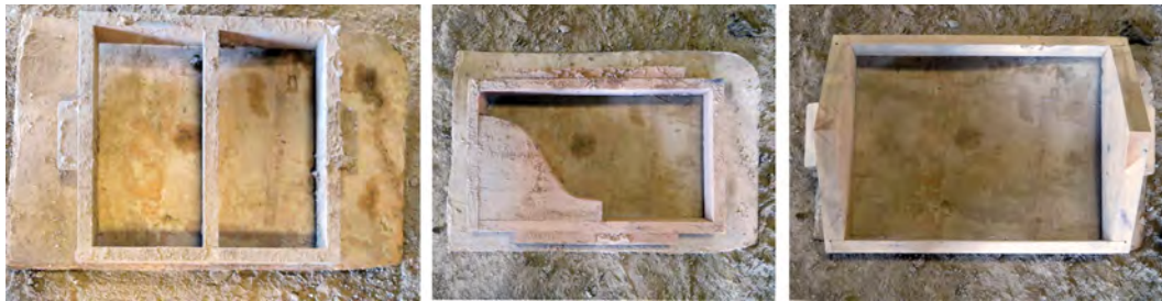
Figura 8. Algunos de los moldes de madera o mercales de las piezas: a la izquierda un molde para hacer dos adobes junto, el del centro molde para realizar un ladrillo moldurado y el de la derecha es un molde para realizar una albardilla de remate de un muro por ese motivo presenta los laterales con forma triangular, de la cerámica de Arévalo. Fotografía de los autores.
