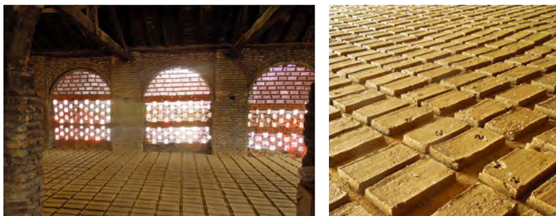
Figura 4. La primera nave de la cerámica con los adobes secándose a la sombra. Las huellas de un gato en la tanda de adobes, a la derecha, dan idea del estado en el que está el barro cuando se desmoldan las piezas. Fotografía de los autores.
