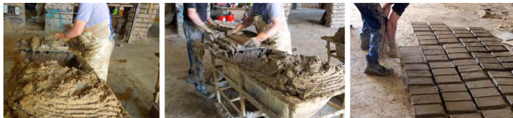
Figura 3. Elaboración de las piezas adobe o ladrillo: en el tablero colocado sobre la bañera se sitúa el “mercal” o adobera que se rellena de barro mano, una vez relleno el molde se pasa el rasero, el otro artesano traslada el mercal con la masa de barro sobre una plancha de plástico rígido y deposita las piezas sobre el terreno. Fotografía de los autores.
