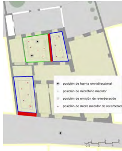
Figura 4. Posiciones de las fuentes y los micrófonos durante el ensayo A y el ensayo B. Fuente: Los autores.
