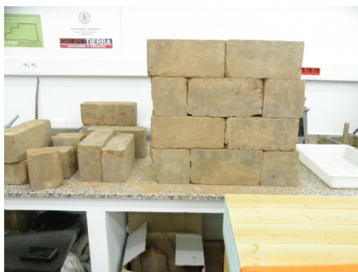
Figura 5. Replanteo del muro de BTC a ensayar
