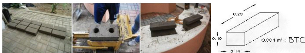
Fig. 8.- Observamos los diferentes tipos de bloques que se pueden realizar con la CINVARRAM, esto siempre y cuando conociendo el debido uso de los accesorios y acoples con que cuenta. De la misma manera observamos que el BTC macizo es el más usado, pero hay que recalcar que existen bloques diferentes tanto en el aspecto formal como en el aspecto funcional, cada uno de acuerdo a sus necesidades. (Fuente Francisco Vera, Alejandro Mendoza, Andrea Intriago)
