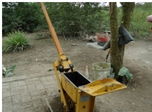
Fig.5.- Máquina CINVA-RRAM actualmente utilizada para la elaboración de los BTC's en el sitio El Aromo del Cantón Manta (Fuente Francisco Vera)
