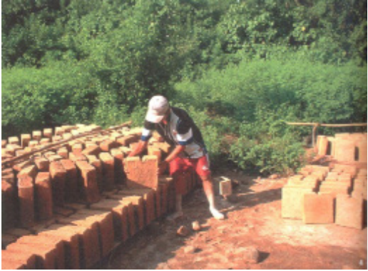
Fig.6.-Adobes ya fabricados puestos a secar al sol. Fuente: L. González
