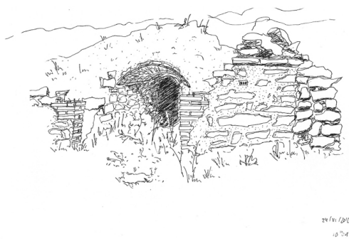
Dibujos de los diferentes tipos de entradas en bodegas del cerro de Villaconancio. De izda a dcha: de dintel plano, romana (caída), romana (mejor conservada), dintel vasto, y otras soluciones. Autor: Boris Aparicio.
