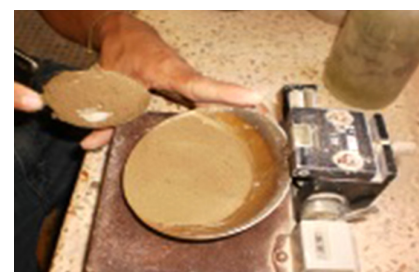
Figura 11. Ensayo de plasticidad con la Casagrande.
