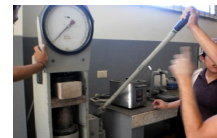
Figura 12. Ensayo de compresión de bloque de perfil en la máquina de compresión de ensayos para probetas de hormigón.
