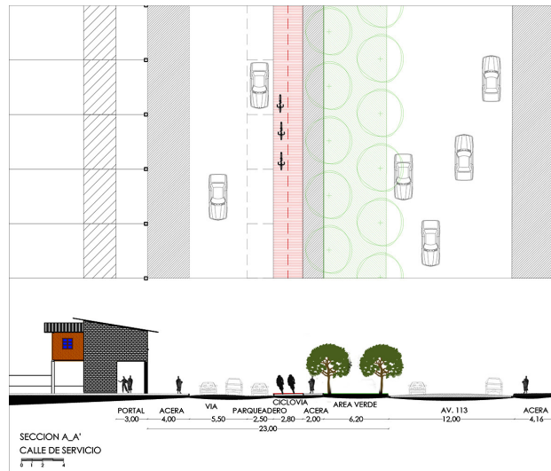
Figura 22. Sección calle de servicio.
