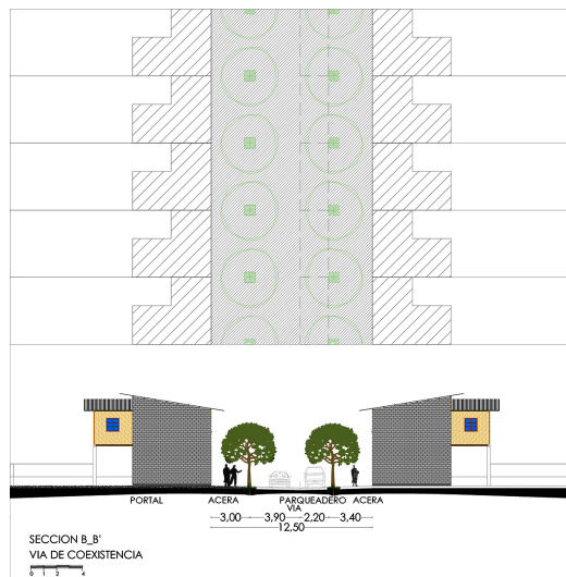
Figura 23. Sección vía de coexistencia.
