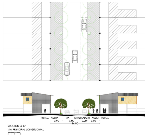
Figura 25. Sección vía principal longitudinal.
