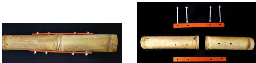
Figura 03. Unión en prolongación longitudinal propuesta por el Profesor Arquitecto Jorge Morán Ubidia.
