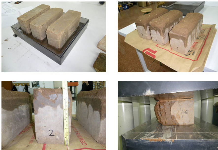
Figura 03. Diversos momentos del ensayo de simulación de humedad extrema por inmersión de la testa del BTC y ensayo de rotura a compresión. Grupo de Investigación en Tecnología de la Construcción con Tierra, UVA (España).
