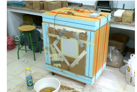
Figura 04. La caja con el muro instrumentalizado.
