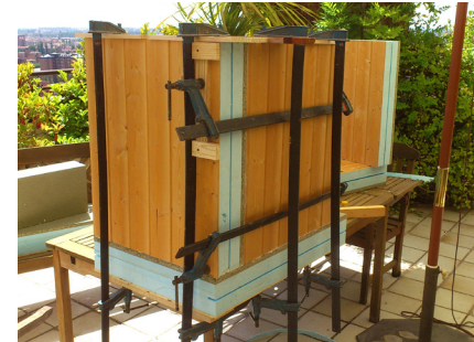
Figura 03. Encolado y ensamblaje de los paneles
