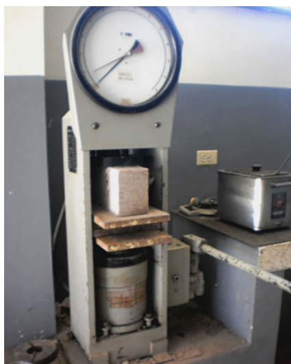
Figura 06. Prensa para el ensayo de compresión simple y tanque de inmersión para la ejecución de ensayo húmedo. (Fuente Alejandro Mendoza – Andrea Intriago)
